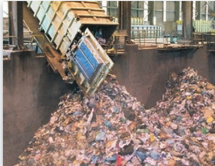
Foso de recepción de residuos no complexo de Cerceda
